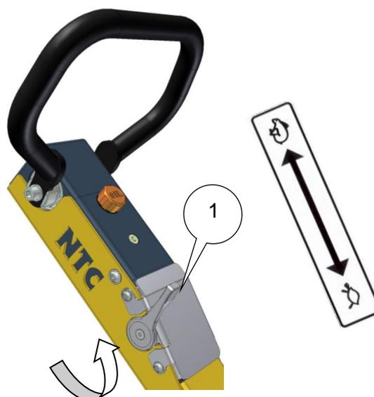
5. Ovládací páka reversu se automaticky překlápí dopředu a stroj vyjede vpřed.
