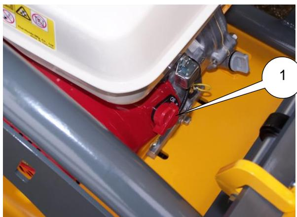
3. Přesuňte páčku sytiče (1) do polohy zapnuto „ON“.
