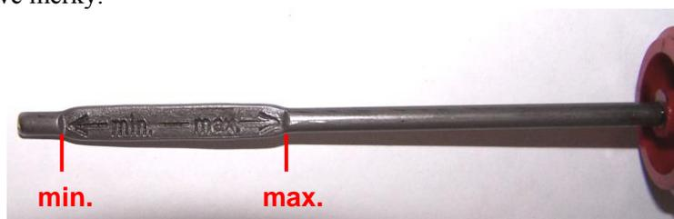
Je-li hladina oleje pod úrovní měrky „min.“, doplňte do motoru doporučený olej až k horní značce stupnice měrky „max.“
