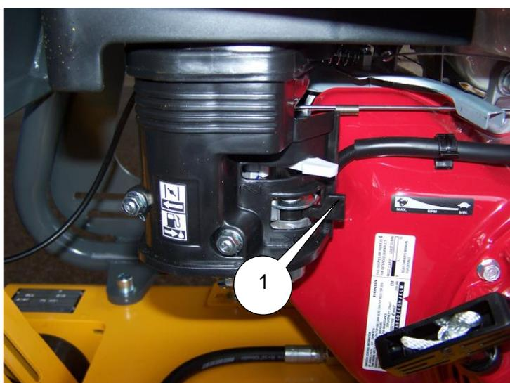
2. Zapněte spínač zapalování motoru (1) do polohy „ON“.
