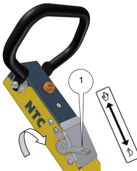
**POZOR!!!** Páka plynu (1) má pouze dvě možné polohy použití – „volnoběh“ a „plný plyn“. V případě regulace otáček motoru pákou plynu, tzn. využíváním jiných poloh než krajních, může dojít k vážnému poškození odstředivé spojky!
